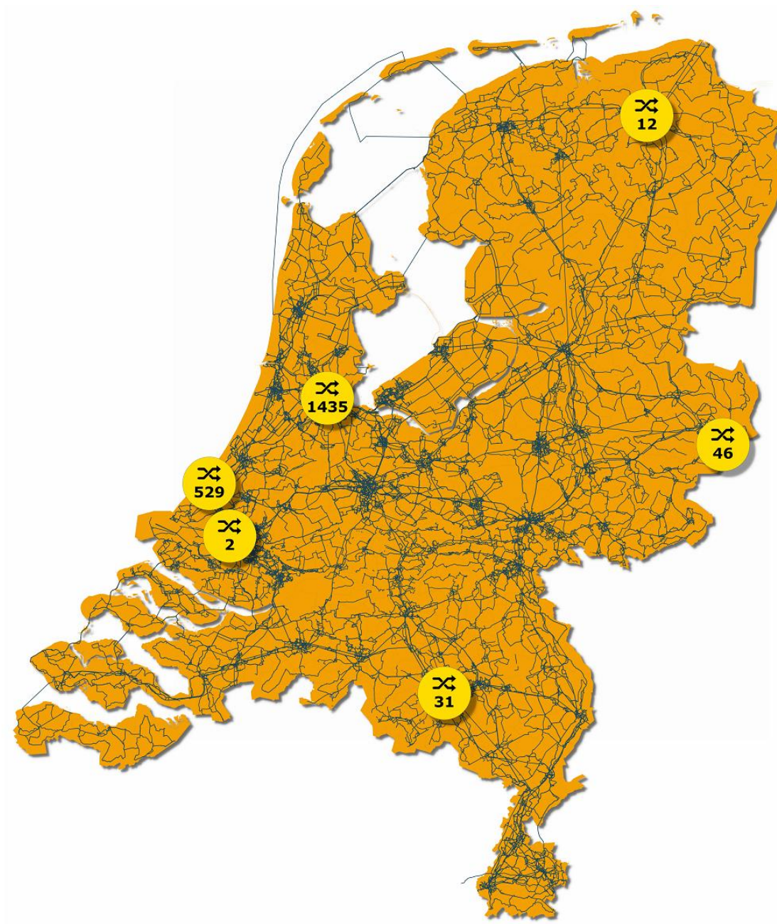
Figuur 33. Overzicht van Internet exchanges in Nederland (excl. opstappunten) en het aantal aangesloten peers 155
