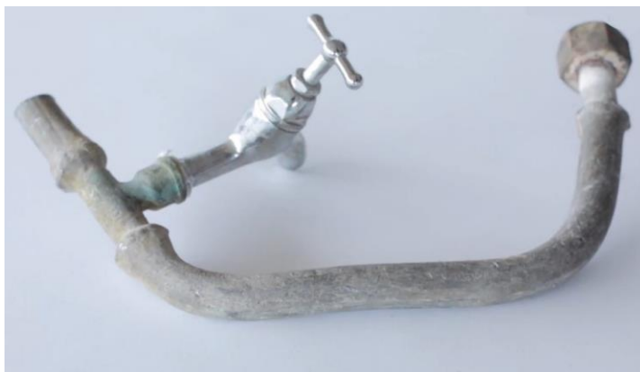
Figuur 3 : Loden leiding (bron: Drinkwaterplatform)
