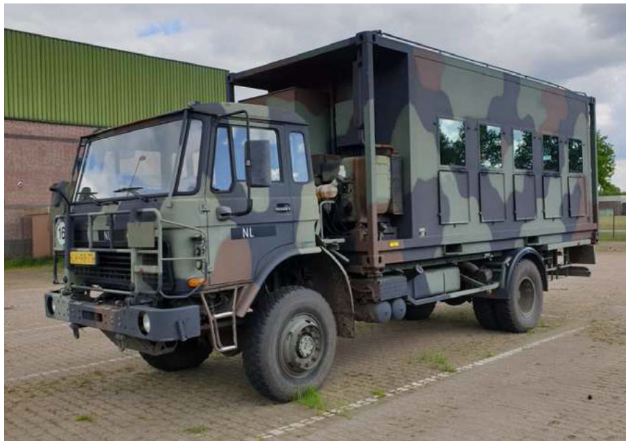
Figuur 3 DAF personeelscontainer is een vierwielaangedreven vrachtwagen met daarop een container gemonteerd, en zo geschikt voor het vervoer van 22 personen.
