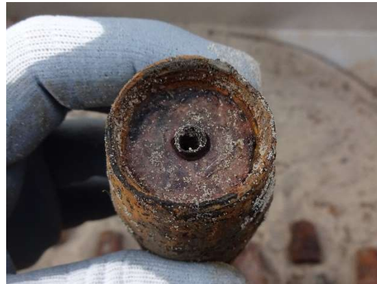
Figuur 23 Explosieve lading onder afgebroken punt met schokbuis.
