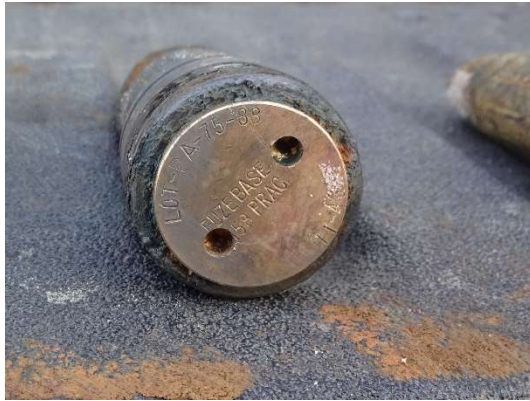
Figuur 30 Detailfoto van een M58 bodembuis.
