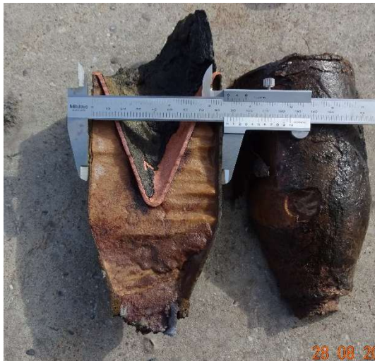
Figuur 18 M2 na doorsnijden en voor verwijderen van de explosieve lading. Opening in de wand zichtbaar in rechterhelft.
