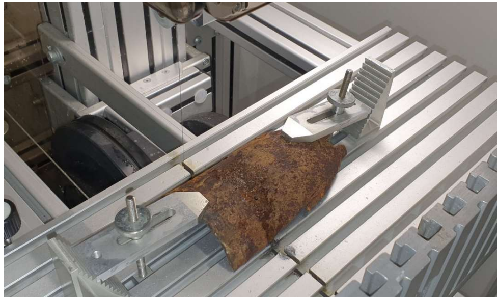
Figuur 12 Deel M28A2 holle lading (M2) bij het diamantzagen.
