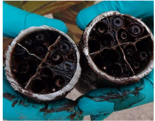
Figuur 56 Dwarsdoorsnede van de M10 raketmotor met buisjes rookzwak kruit.
