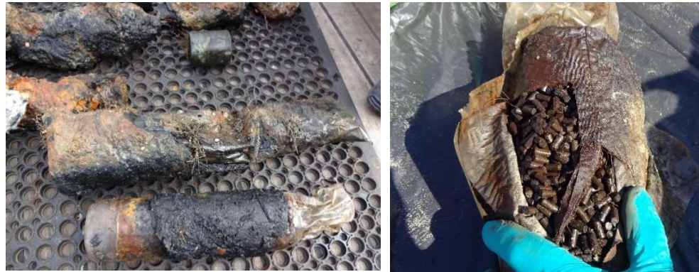
Figuur 61 M13 en M15 kardoezen direct na berging. Figuur 62 7-gats kruut afkomstig uit M13.
