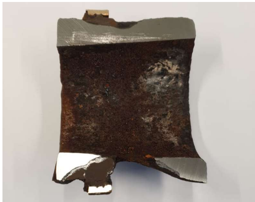
Figuur 40 Foto M17-2 met radiale doorsnede ter hoogte van geleideband.
