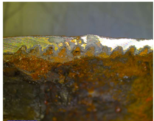
Figuur 58 Detail schroefdraad M10-2 (radiale doorsnede).
