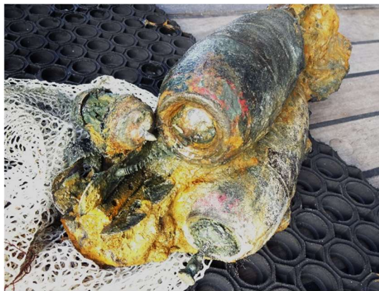
Figuur 46 3" mortier granaten (M7) met restanten ontstekers.
