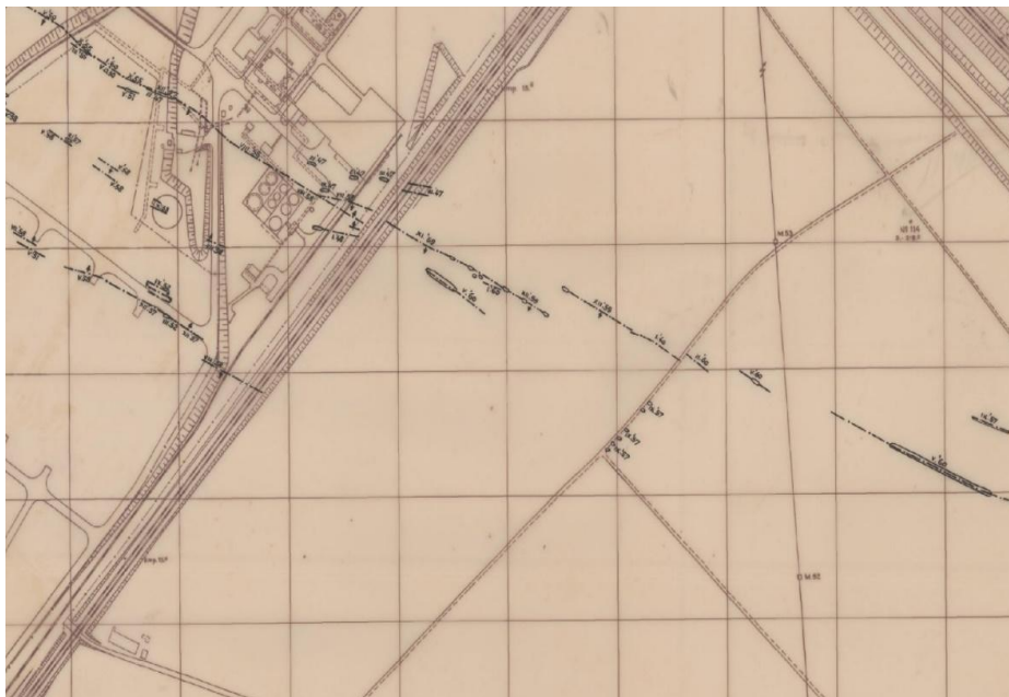
Figuur 44. Scheurenkaart van het zuidelijk deel van het mijnterrein van de Maurits met drempels en soms langwerpige verzakkingen uit de tijd van de steenkoolwinning.
