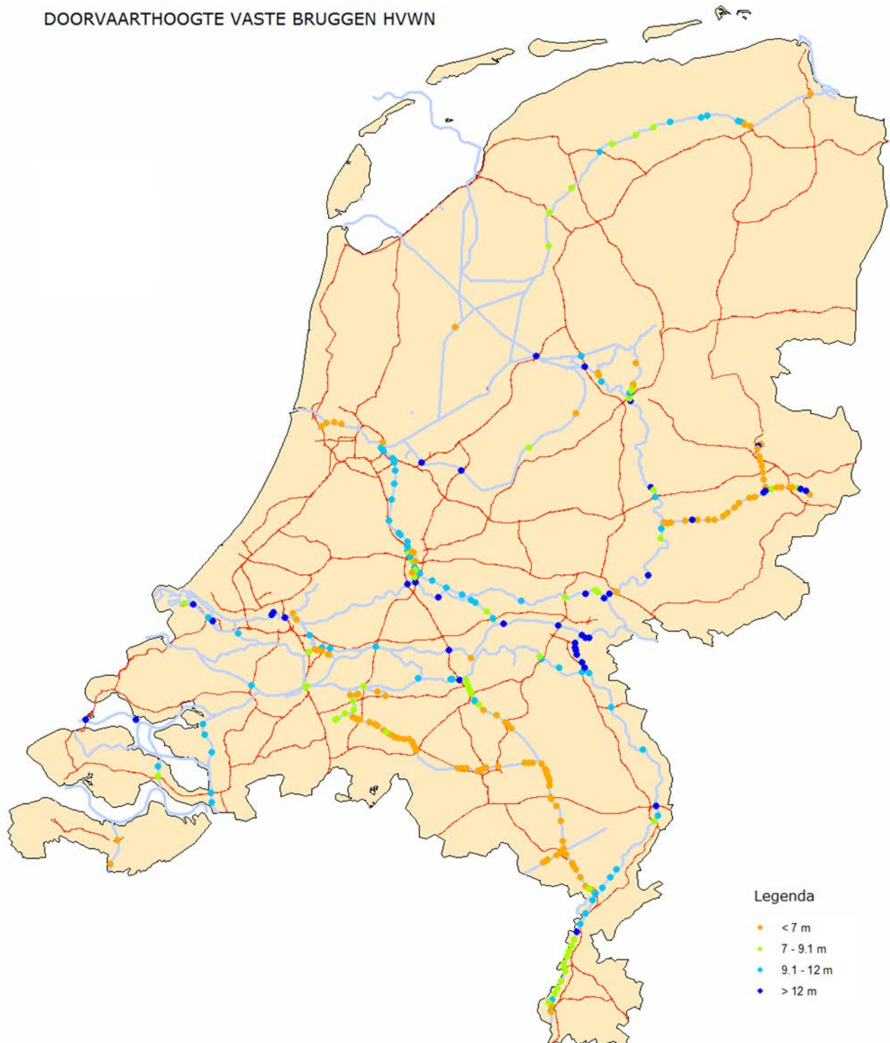
Figuur 30. Doorvaarthoogte vaste bruggen over HVWN (bron: ViN, BIVAS)
