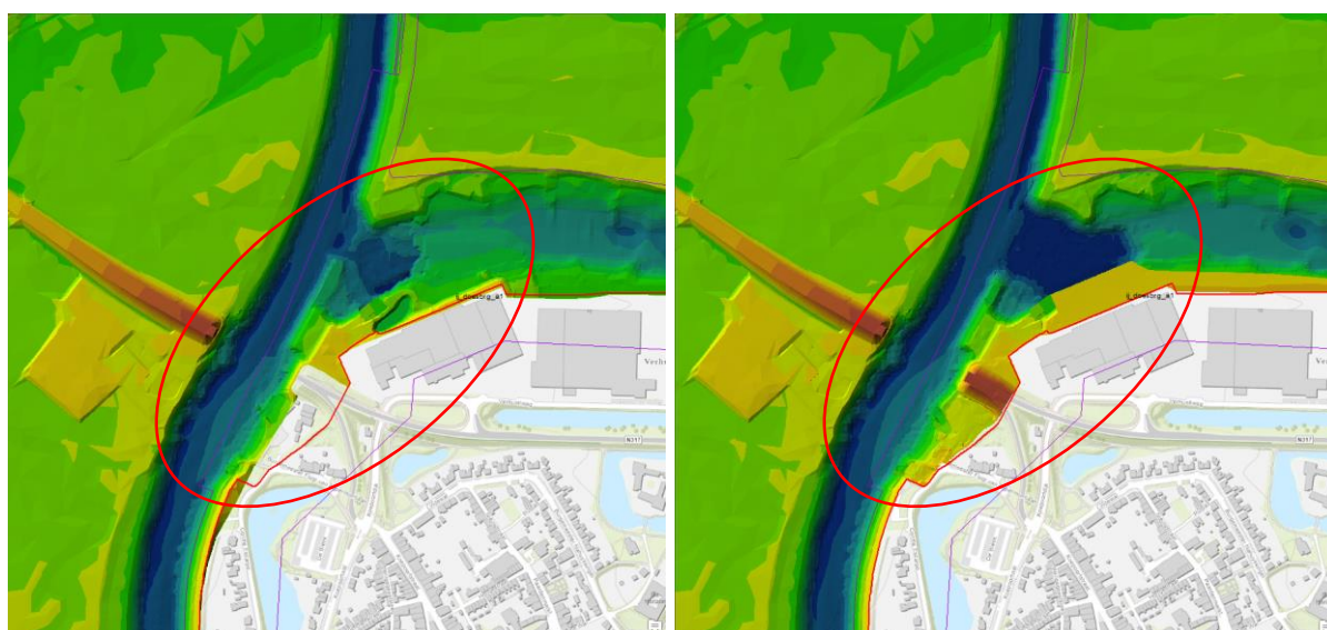
Figuur 11. Voorbeeld van actualisatie van de bodem bij Doesburg (links J19-model, rechts na actualisatie (V5)).
