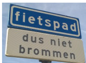
Afbeelding 7. Onderbord om aan te geven dat snorfietzen met verbrandingsmotor niet op een onverplicht fietspad zijn toegestaan Foto: Donald Trung Quoc Don 4
