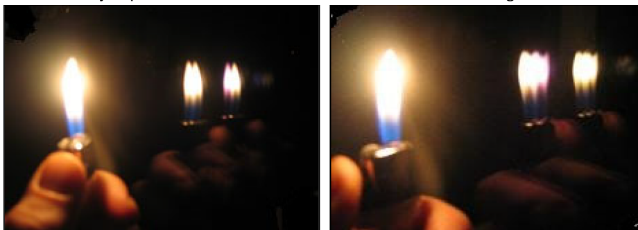
Afb. 2 Aantonen HR coating door verkleuring van de reflectie (links de derde reflectie, rechts de tweede)
