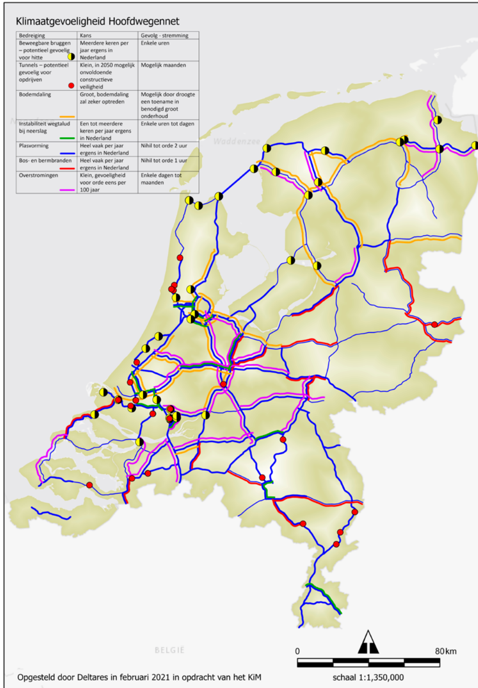
Gevoeligheid van het Hoofdwegennet voor zeven negatieve effecten die door het klimaat beïnvloed worden. (Klimaatverandering en het mobiliteitssysteem, KIM, juli 2021)
