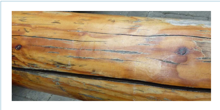
Figuur 8: Windscheur in giek van de Risico.
