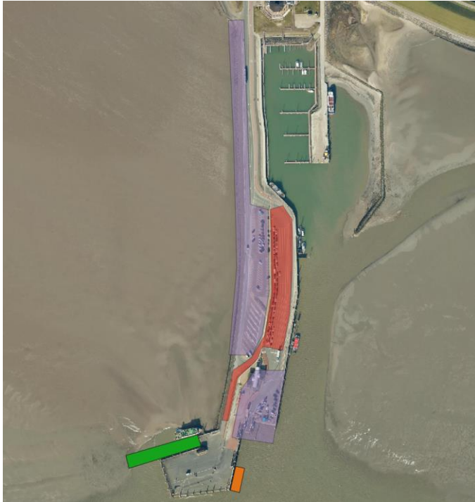
Afbeelding 2.23 Indicatieve weergave eerste deel van ophoging (paars), tijdelijke opstelstroken inclusief aanrijroute (rood), tijdelijke locatie autoveer (groen) en tijdelijke locatie sneldienst (oranje)
