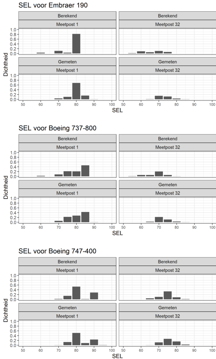
Figuur 16 Vergelijking van de distributies van berekende en gemeten geluidniveaus (SEL) voor de Embraer 190 (boven), Boeing 737-800 (midden) en Boeing 747-400 (onder) voor meetpost 1 (links) en meetpost 32 (rechts).
